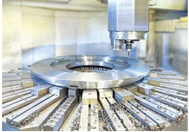
Mâm cặp lai kết hợp mâm cặp trung tâm cổ điển và mâm cặp từ tính tròn. Họ định tâm các phôi và kẹp chúng mà không có biến dạng.
